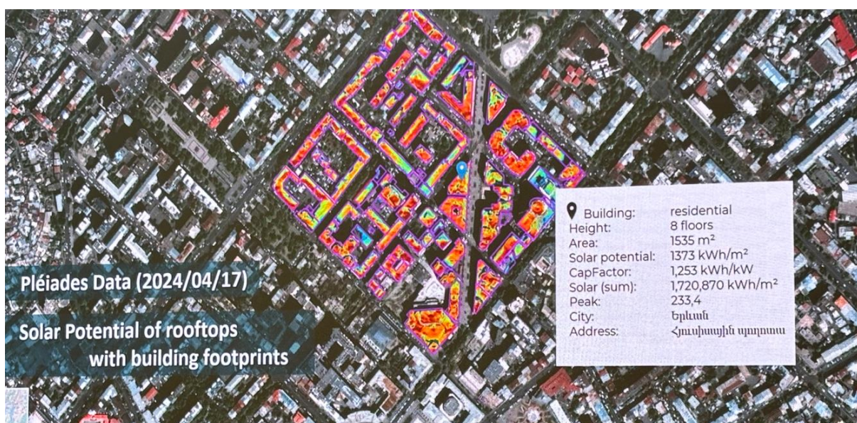
Abbildung 5: Beispielhafte Bestimmung des Solarpotentials aus optischen Satellitendaten
