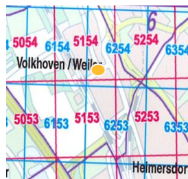
Abb. 4.6: Anordnung der Gitternetze (blau: Gauß-Krüger-System, rot: ETRS89/UTM)
