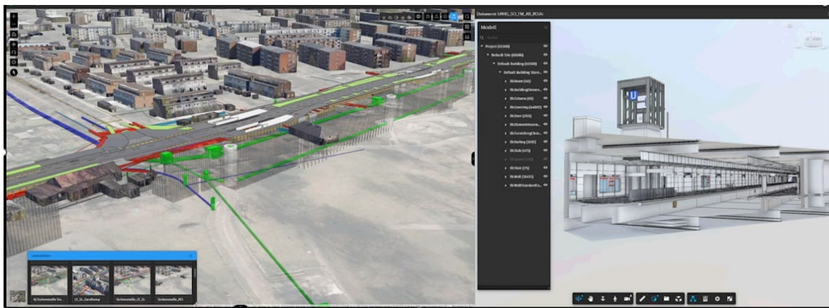
Abb. 3.2.7-2: Integration Gesamtmodell U4 in ArcGIS GeoBIM und Verknüpfung mit BIM360
