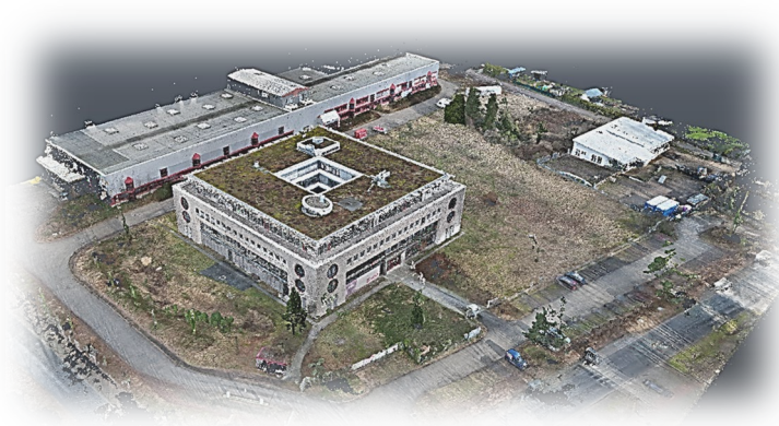
Abb. 3.1.17-3: Akademiegebäude aus terrestrischer und UAS- Photogrammetrie
