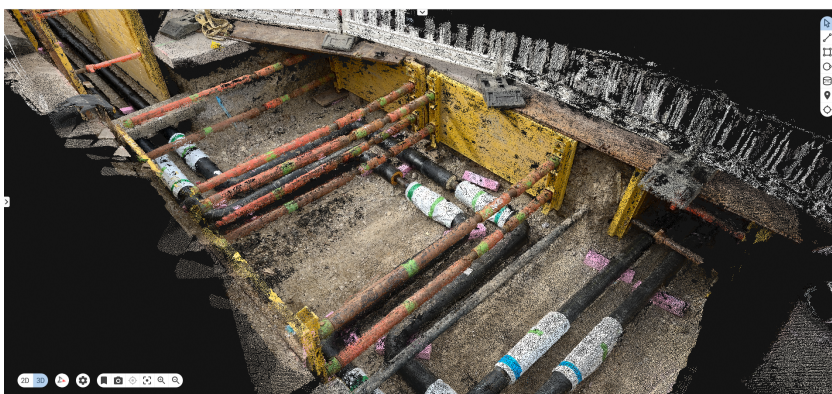
Abb. 3.1.19-3: Messergebnisse des 3D-Scannings in der Cloud
