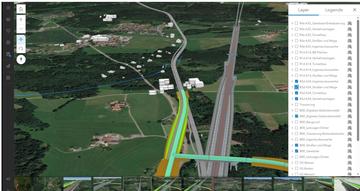
Abb. 3.2.7-1: BIM-GIS-Integration - Gesamtmodell Brenner Nordzulauf in ArcGIS online
