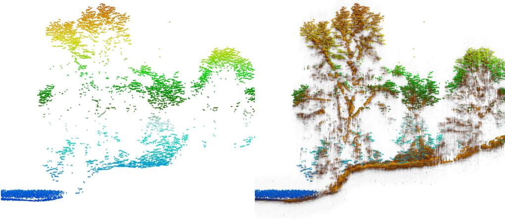
Abb. 6: Querschnitt durch dichte Ufervegetation. Punkte aus der OP bei der Datenaufnahme eingefärbt nach Höhe (links) und zusätzlich dargestellter Verlauf der FWF-Signale mit besser erkennbarer Geländegeometrie unterhalb der Vegetation (rechts).
