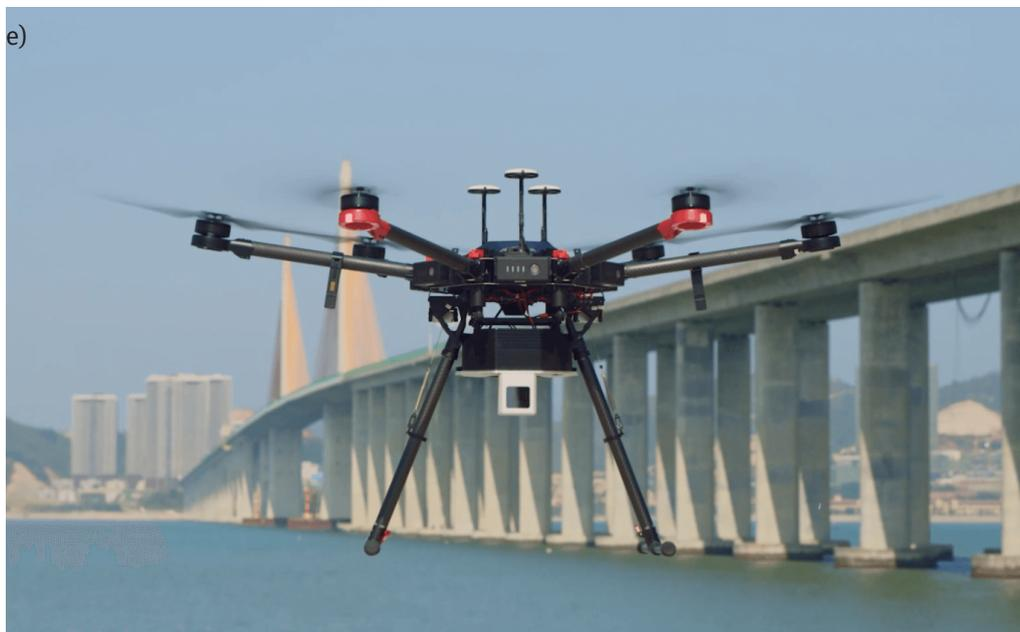
Ausgewählte UAS-LiDAR-Systeme: a) Riegl miniVUX-1UAV, b) YellowScan, c) Velodyne LiDAR Puck, d) Routescene LidarPod, e) LIVOX Optoelektrisches System mit rotationsfreien photoelektrischen Komponenten
