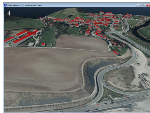
Abb. 3.2.2-9: Kombination aus DGM mit Luftbild auf der Oberfläche und 3D-Gebäuden in der 3D-Projektansicht.
