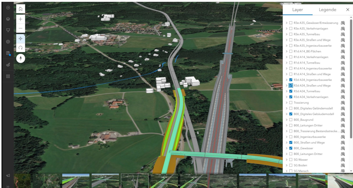
Abb. 3.2.7-1: BIM-GIS-Integration - Gesamtmodell Brenner Nordzulauf in ArcGIS online
