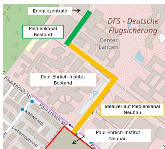
Abb. 3.1.14-1: Übersicht des bestehenden (grün) und neu geplanten (orange) Medienkanals (Quelle der Hintergrundkarte: OpenStreetMap)
