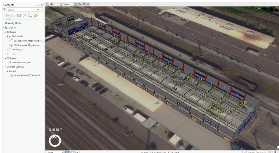
Abb. 3.2.8-1: 3D-Bestandsmodell in ArcGIS Pro mit Sicht ins Innere der Halle
