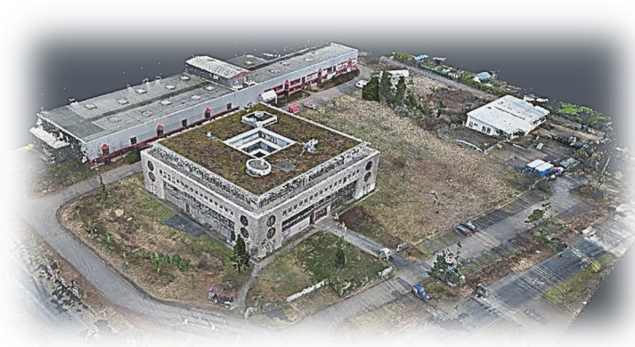
Abb. 3.1.17-3: Akademiegebäude aus terrestrischer und UAS- Photogrammetrie
