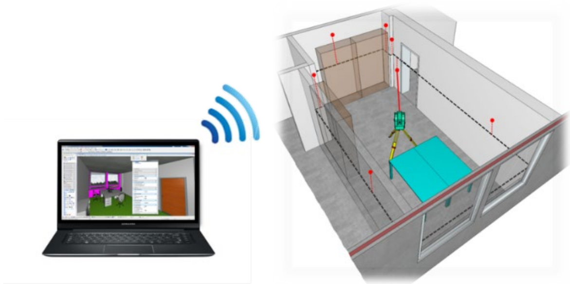
Abb. 2.4-2: Prinzip der Einzelpunkt-basierten Erfassung und Modellierung für BIM.
