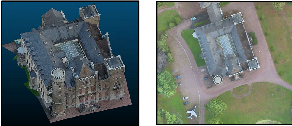
Abb. 3.1.17-1: Punktwolke (links) und DOP (rechts) aus UAS- Daten
