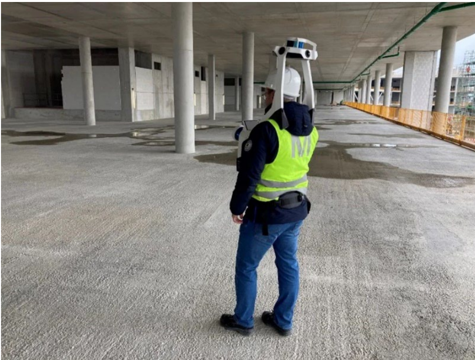
Abb. 3.1.15-1: Scannen auf der Baustelle mit dem NavVis VLX
